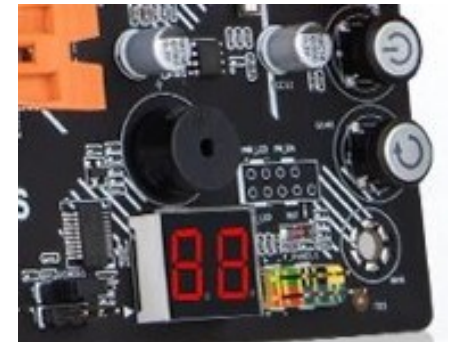
Altavoz piezoeléctrico integrado en placa
