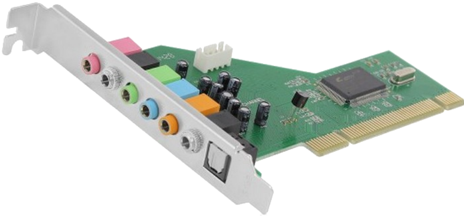
Tarjeta de sonido PCI de 32 bits universal (3,3 y 5V)
