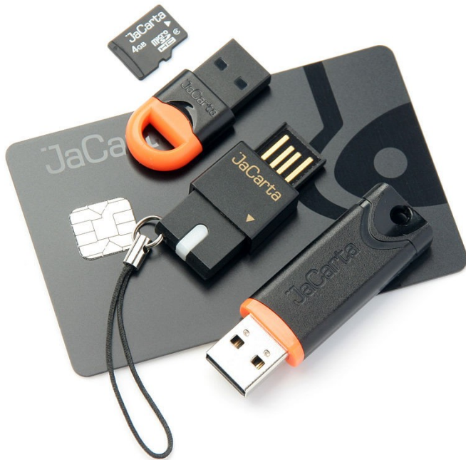
Ejemplos de distintos tipos de memorias flash: Smart card, tarjeta SD y tres tipos de pendrives USB
