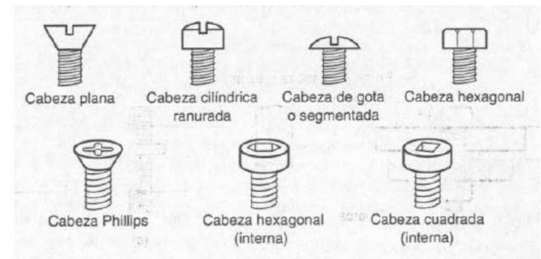
TIPOS DE CABEZAS DE TORNILLOS
