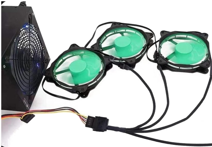
Adaptador alimentación SATA a 4 conectores de 3 pines Enlace amazon
